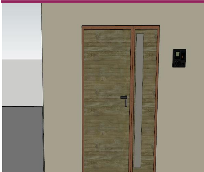
Figura 3: Sistem control acces cu cartelă
